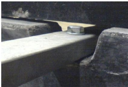
Die 3 Stk. Konsolen (2) mit Querbalken (3) mittels Schrauben M-16 (5) und U-Scheiben (6) verbinden. Mit Wasserwaage ausrichten. Dabei Schrauben fest anziehen, jedoch nicht „überdrehen“. Anschließend „festen Stand“ der Konsolen in Längs- und Querrichtung überprüfen, die Unterkonstruktion darf nicht wackeln oder schwingen.
